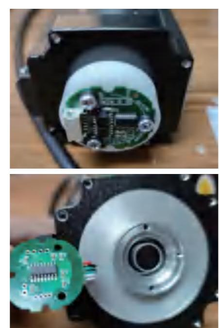
“信号线从14根线减少到6根！”深圳市立三机电有限公司相关负责人介绍，公司新产品单圈绝对值磁编码器，只需要6根信号线，就可以实现目前市场上常用的编码器所使用的14根线的功能，而且可以准确获得转子的绝对位置，甚至对电机的控制效果要更优。这不仅节约了成本，而且减少了用户接线的烦恼。
